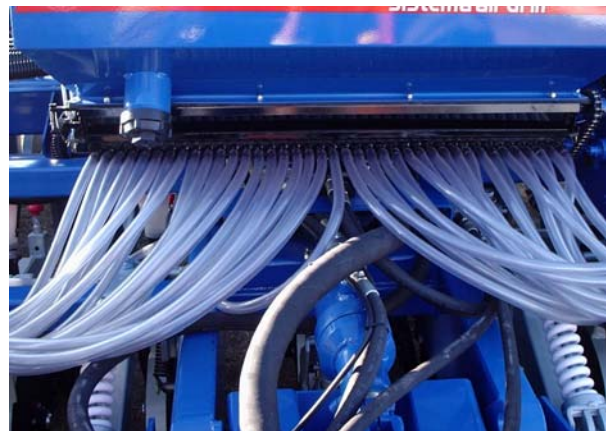
Vista equipo de 39 líneas de aplicación
