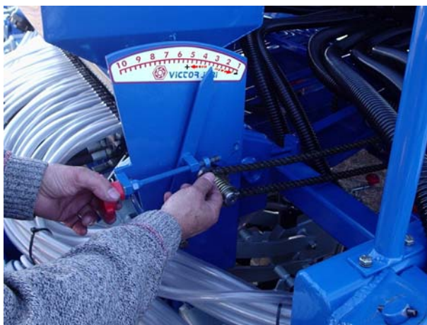
Regulación de la dosificación
