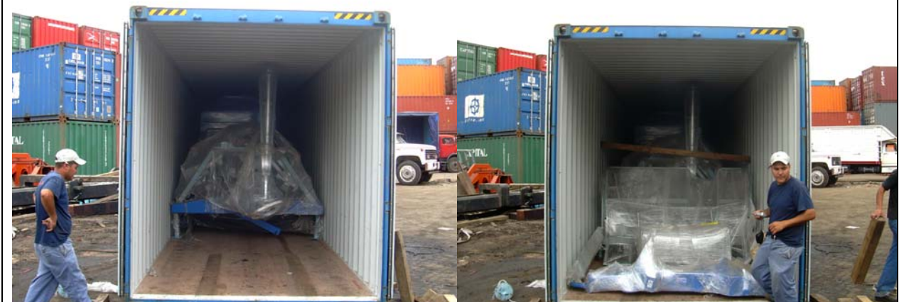
Consolidación sobre contenedor High Cube. (Tareas de carga , vistas de la maquina y partes desmontadas previos al cierre y precintado del contenedor)
